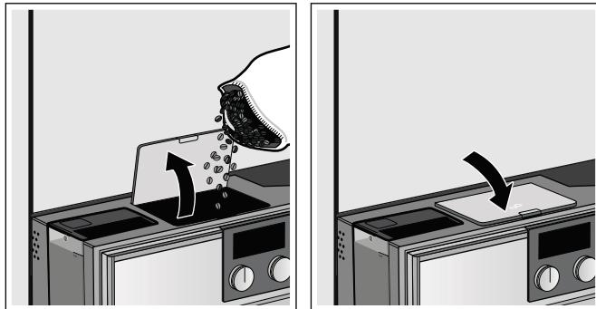
**Указание:** Глазированные, карамелизированные или содержащие другие сахарные добавки кофейные зёрна вызывают закупоривание заварочного блока. Используйте только чистые смеси кофейных зёрен для приготовления эспрессо или автоматических кофемашин.
