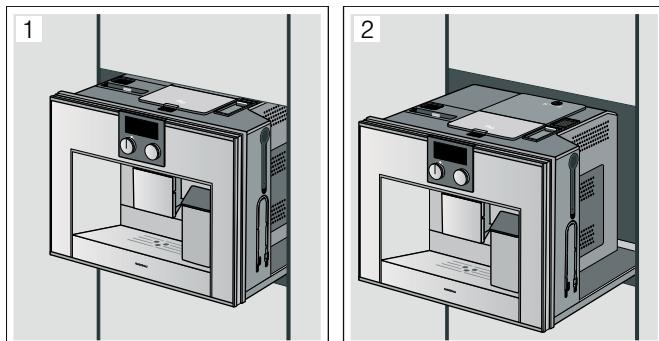
В положении для доступа 2 можно извлекать заварочный блок и регулировать степень помола. Затем снова задвиньте прибор до упора в кухонный гарнитур.
