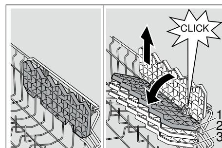
\* В зависимости от модели существует 3 положения установки полки по высоте. Для этого сначала установите полку вертикально и поднимите вверх, а затем, установив в легком наклонном положении, переместите ее вниз на желаемую высоту (1, 2 или 3) и зафиксируйте на месте (слышен щелчок).
