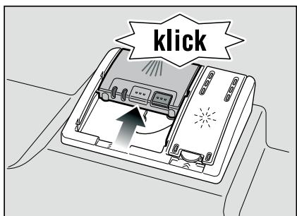
Камера с моющим средством открывается автоматически в зависимости от выбранной программы в самый подходящий для этого момент времени. Порошкообразное или жидкое моющее средство распределяется внутри машины и затем растворяется, таблетка падает в предназначенную для нее подставку и, находясь в ней, постепенно растворяется.
