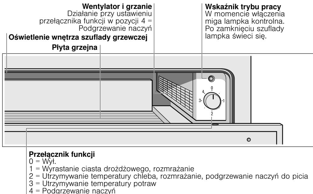
Urządzenie grzeje tylko wtedy, gdy szuflada jest prawidłowo zamknięta.
