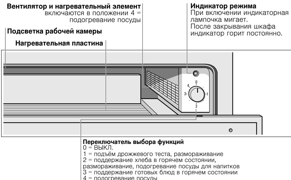
Прибор нагревается, только если он закрыт надлежащим образом.
