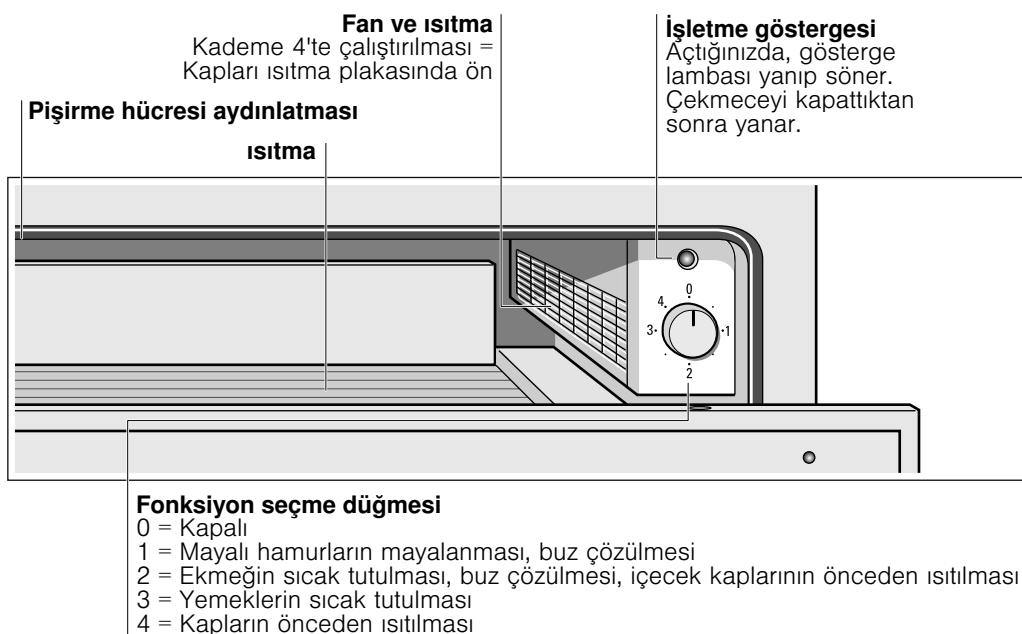
Cihaz ancak çekmece doğru olarak kapatıldığında ısıtır.
