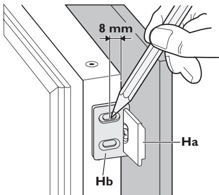
11. Nehmen Sie das Führungsstück ab. Markieren Sie 8 mm von der Außenkante entfernt die Stelle, an der der Nagel (K) einzuschlagen ist.
