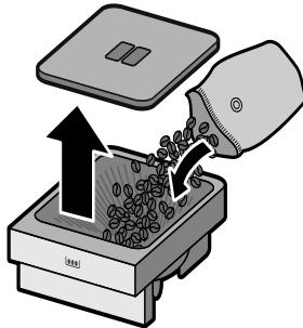
**Указание:** Глазированные, карамелизованные или обработанные другими содержащими сахар добавками кофейные зерна приводят к забивке заварочного блока. Используйте только смеси кофейных зерен, предназначенные для полностью автоматической кофемашины.
