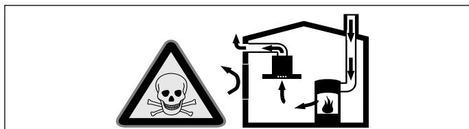
Hava dolaşımı ateşlikler (örneğin gaz, yağ, odun veya kömürle çalışan sobalar, şofbenler, su ısıtıcıları) yanma havasını kurulum yerinden alırlar ve atık gazı bir atık gaz sistemi (örneğin baca) kanalıyla dışarıya aktarırlar.
