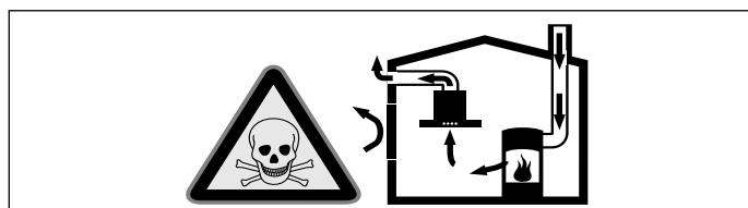
Zależne od powietrza w pomieszczeniu urządzenia spalające (np. grzejniki na gaz, olej, drewno lub węgiel, przepływowe podgrzewacze wody i inne podgrzewacze wody) pobierają powietrze do spalania z pomieszczenia, w którym się znajdują, a spalinę odprowadzają przez układ wylotowy (np. komin) na zewnątrz.
