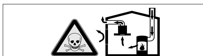
Источники пламени с подводом воздуха из помещения (например, работающие на газе, жидком топливе, дровах или угле нагреватели, проточные водонагреватели, бойлеры) получают воздух для сжигания топлива из помещения, где
